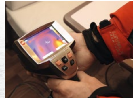
Prüfen der Temperaturen mithilfe einer Wärmebildkamera
