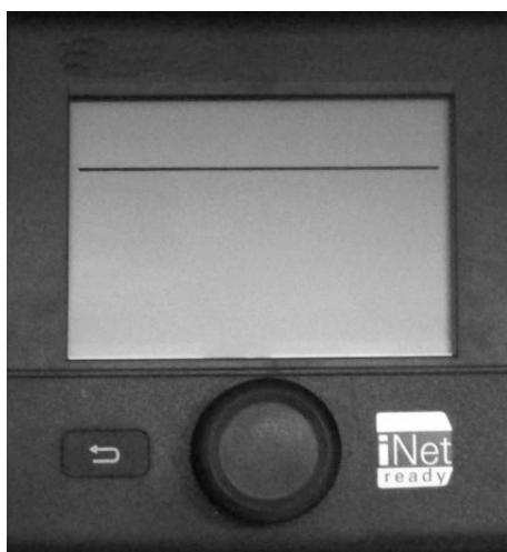
Bild 79: Digital manöverenhet TRUMA CP Plus
