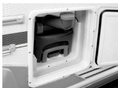
Bild 47: Fekalietank med påfyllningsstuts för spolvatten
